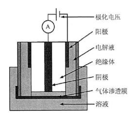
图 1: 极谱法测定原理图
